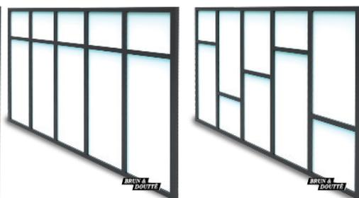
Avec l'option traverse horizontale 30mm alignée ou façon design
